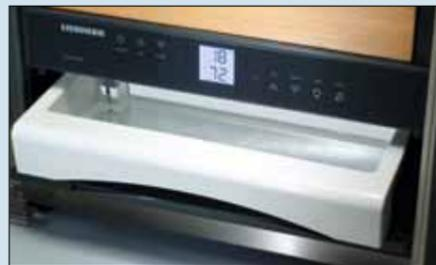
El depósito integrado se puede llenar con hasta un litro de agua destilada. Los sensores de humedad regulan la necesidad de agua y garantizan con precisión el mantenimiento de la **humedad del aire seleccionada entre el 68% y el 75%**. Un indicador óptico informa a tiempo si se ha de rellenar agua (ZKes 453).
