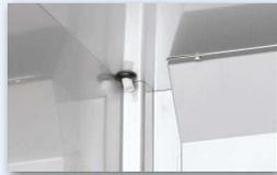
Los aparatos de laboratorio con **control electrónico Profi** disponen de una posibilidad de integración (diámetro de paso de 7,0 mm) en el área del techo que permite la incorporación de un **sensor de temperatura independiente**.
