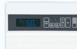
Los aparatos de laboratorio con **control electrónico Comfort** ofrecen una **calibración de 1 punto** que permite una regulación de máxima precisión de la temperatura. Este sistema permite la compensación entre la temperatura regulada y la temperatura real en el interior.
